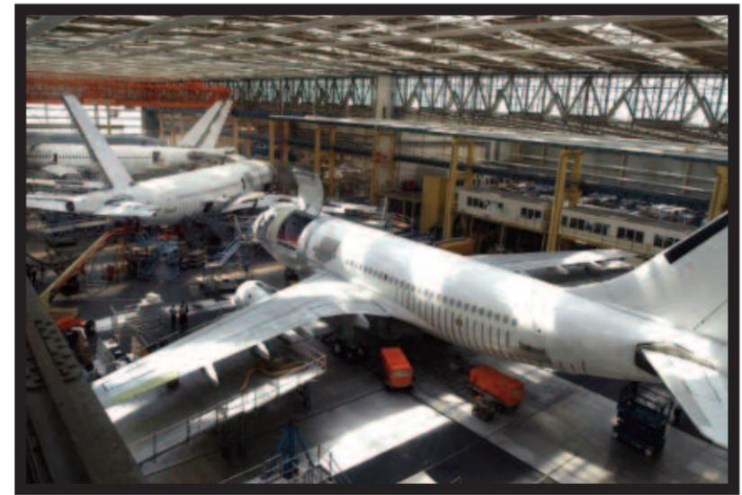
• EADS EFW (Elbe Flugzeugwerke GmbH) est le centre de compétences d'EADS où s'effectue la conversion des avions passagers en avions de fret : A300 et A310 gros-porteurs. © Photothèque EADS
