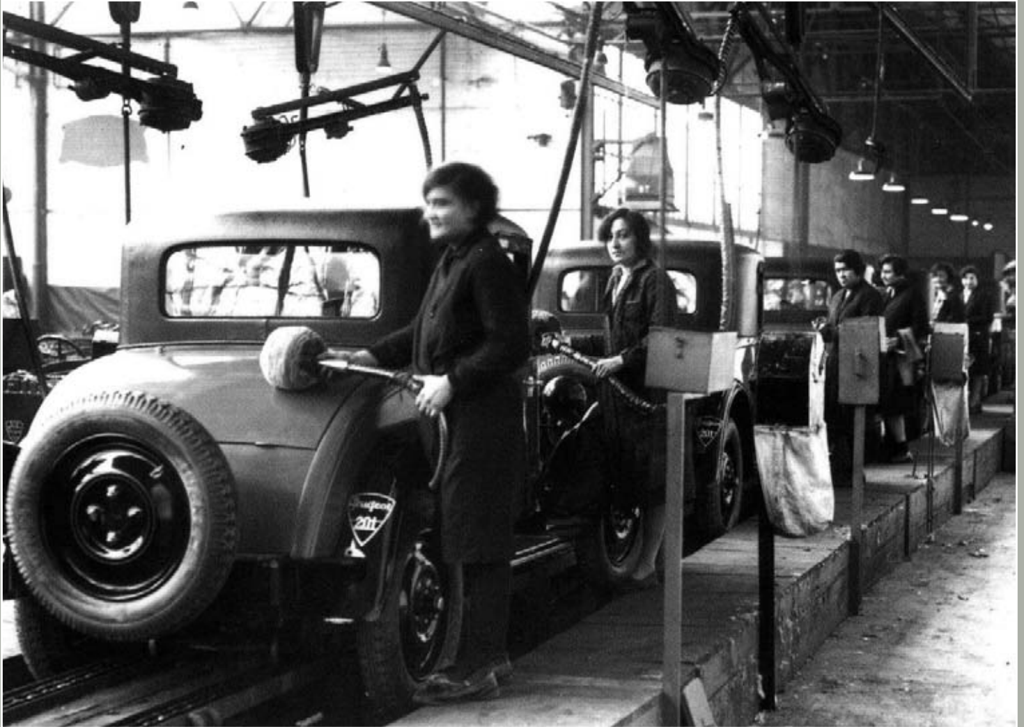
La nouvelle carrosserie de Sochaux au début des années 1930. Des ouvrières (appelées « manoeuvres spécialisées » parce qu'elles n'étaient pas « qualifiées ») effectuent le ponçage de coupés 201 sur une ligne mobile tractée par des chaînes que l'on voit en bas à gauche.
